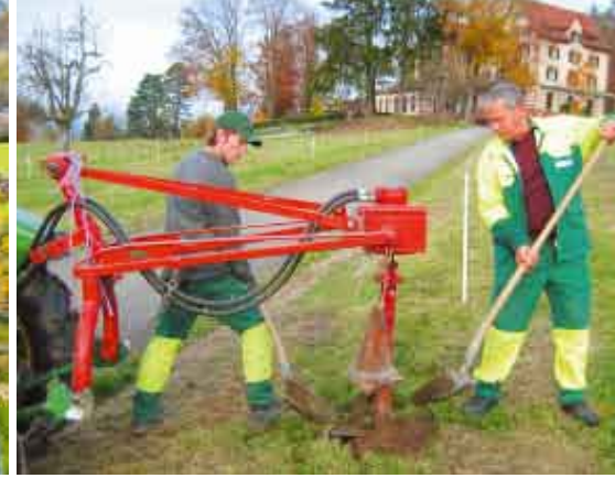
Mit einem Spezialbohrer bereiten Lorenz Kern und Hans Stierli vom Juchhof die Löcher zur Pflanzung vor.
